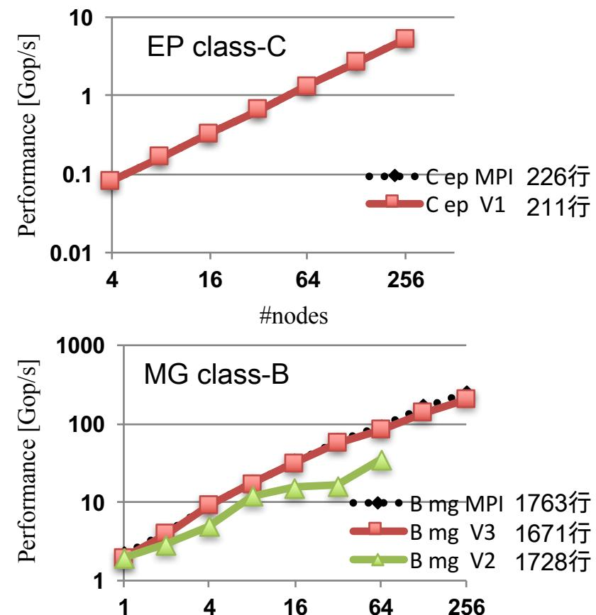
測定環境 京コンピュータ: SPARC64 VIIIfx (8core, 2GHz, 128GFLOPS), 1CPU/node, 100GB/s/node
